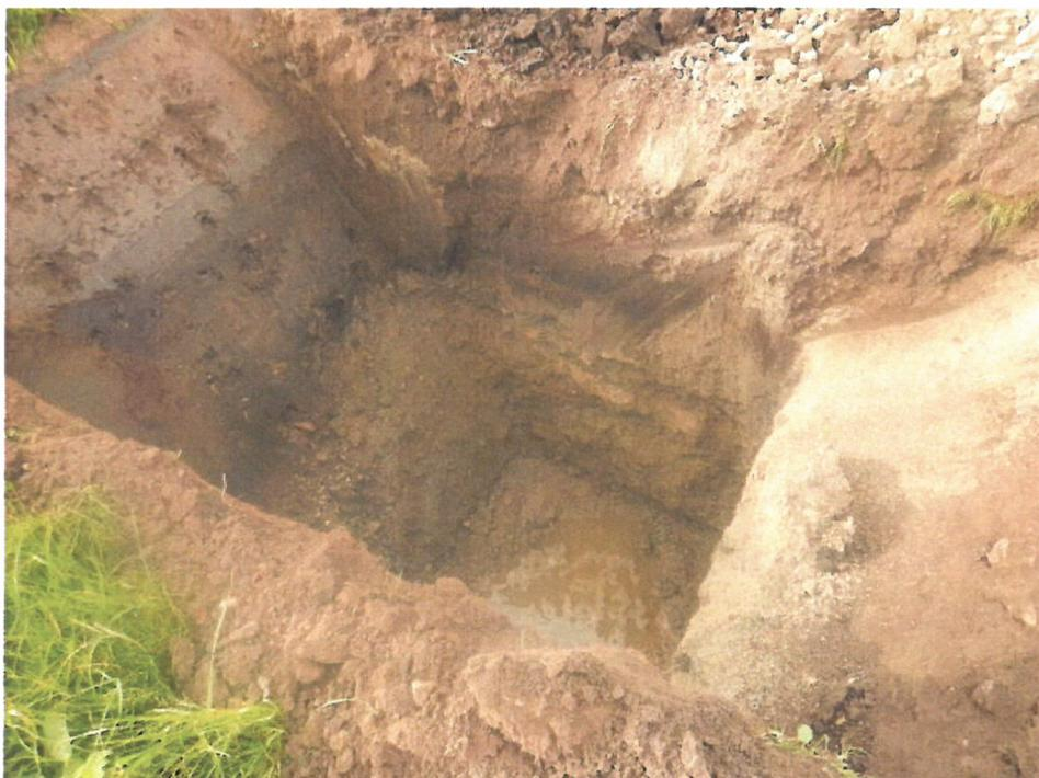
**Bild 3:** Sickerversuch beim Schürf Sch-3/2020
