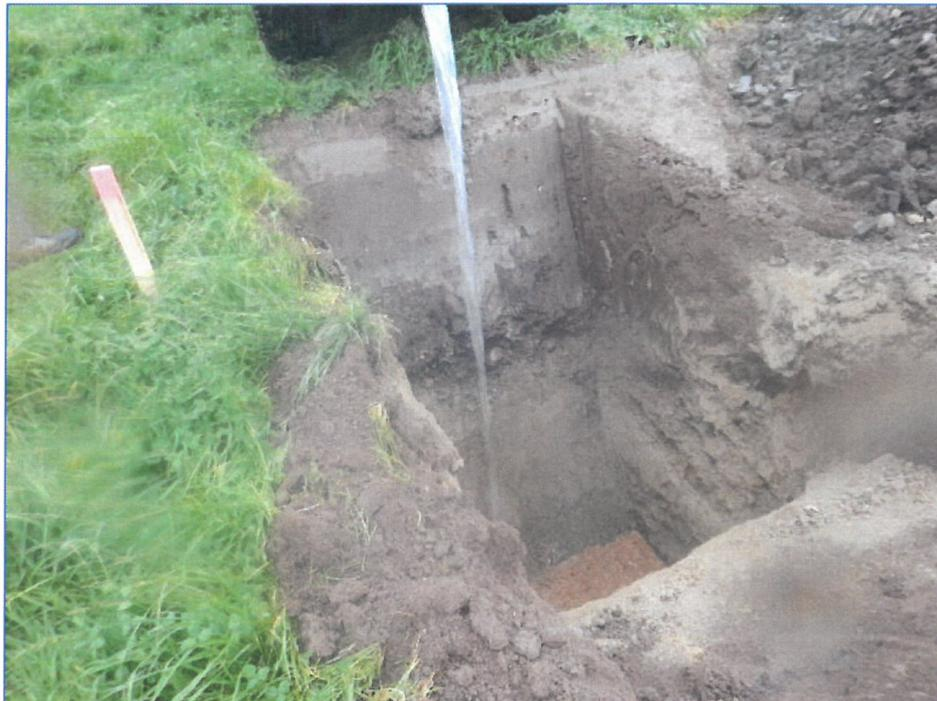
**Bild 2:** Sickerversuch beim Schürf Sch-1/2020
